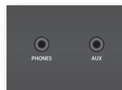
La entrada AUX del panel delantero puede usarse como una entrada analógica usando un cable estéreo de 3,5 mm.
