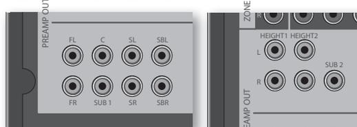
Der AVR ermöglicht auch den Anschluss von zwei aktiven Subwoofern an den SUB -Ausgängen. Sehen Sie in Ihrer Subwoofer-Bedienungsanleitung nach, um die richtige Einstellung und Verbindung für Ihren speziellen Subwoofer zu wählen.
