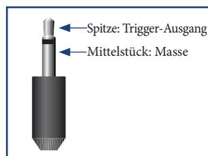
Die Triggeranschlüsse (TRIG Z1 und TRIG Z2) geben ein elektrisches Signal aus, wenn der AVR eingeschaltet und die entsprechende Zone aktiviert wird.
