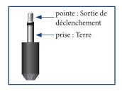
Les connecteurs de déclenchement (TRIG Z1 et TRIG Z2) fournissent un signal électrique à chaque mise en marche de l'AVR et à chaque fois que la zone adéquate est activée.
