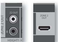
Разъем HDMI Z2 out может использоваться для подключения выходного разъема ресивера AVR к системе, расположенной во втором помещении.
